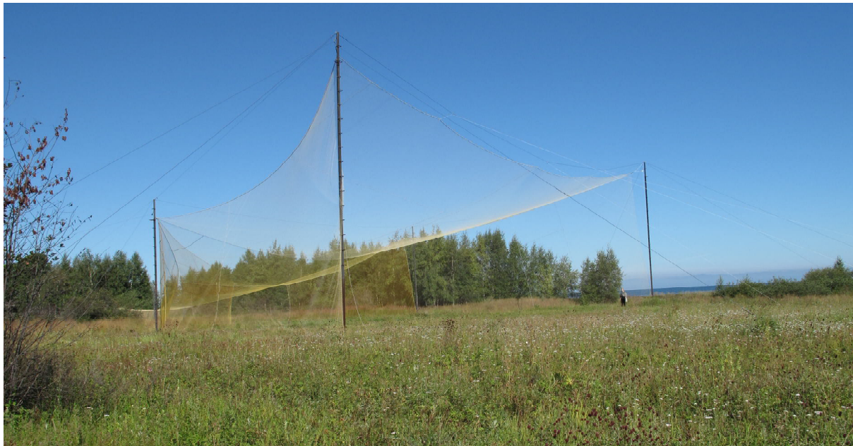
Рис. 1. Орнитологическая ловушка рыбачинского типа на побережье озера Байкал. Размер входных ворот 42 x 13 м. Fig. 1. Ornithological trap of the Rybachinskii type on the coast of Lake Baikal. The size of the entrance gate 42 x 13 m.
